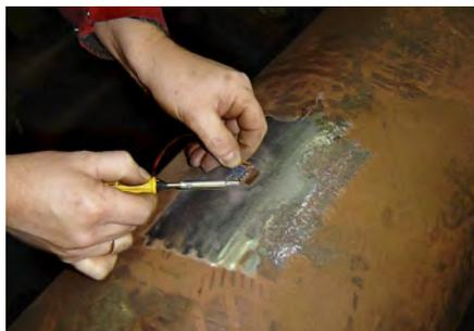
**Fig. 7: Sistemazione di un estensimetro su un albero.**
